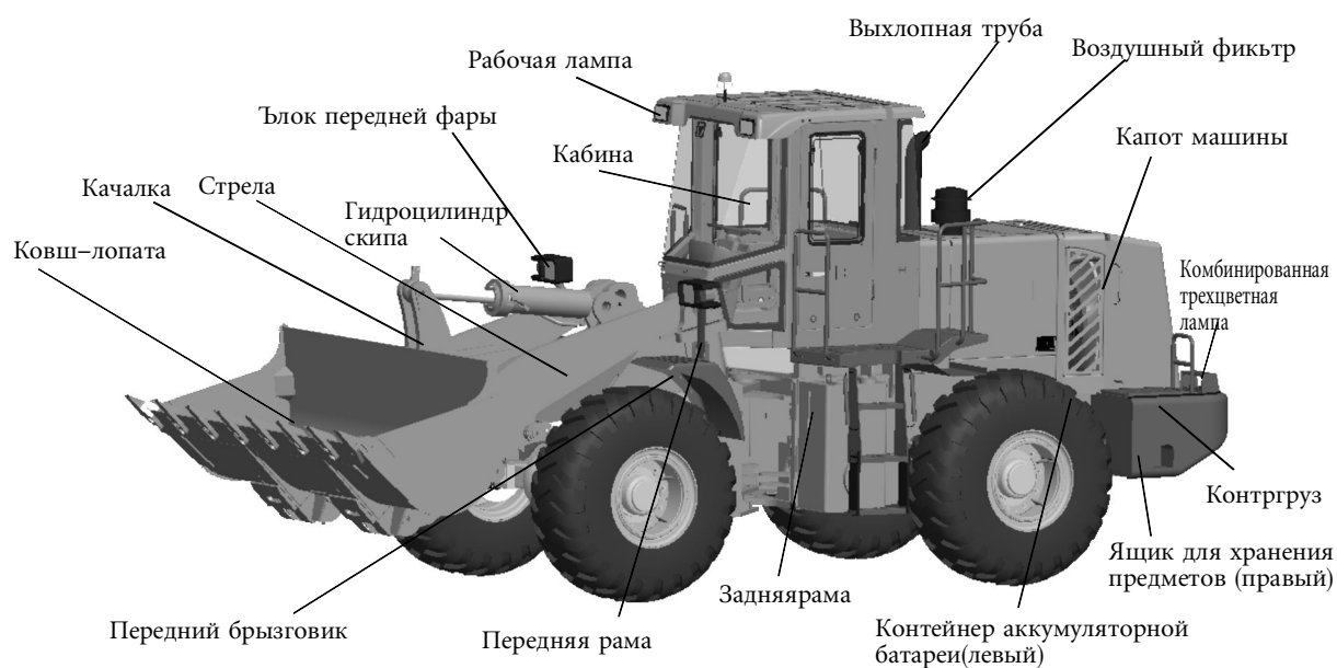
Рис. 1–1 Внешний вид погрузчика, наименование частей и деталей и их схемы
