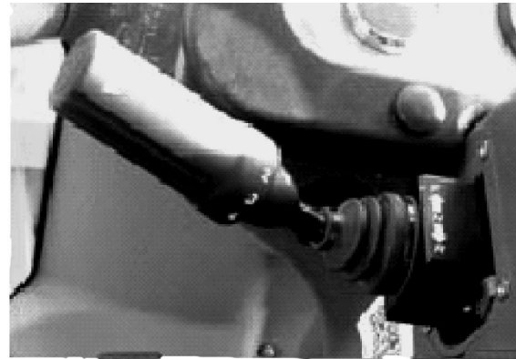
Рис. 1-29 Схема положений управления перемены передач
