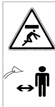
Рис. 1-12 Запрещено движение под рабочим устройством
