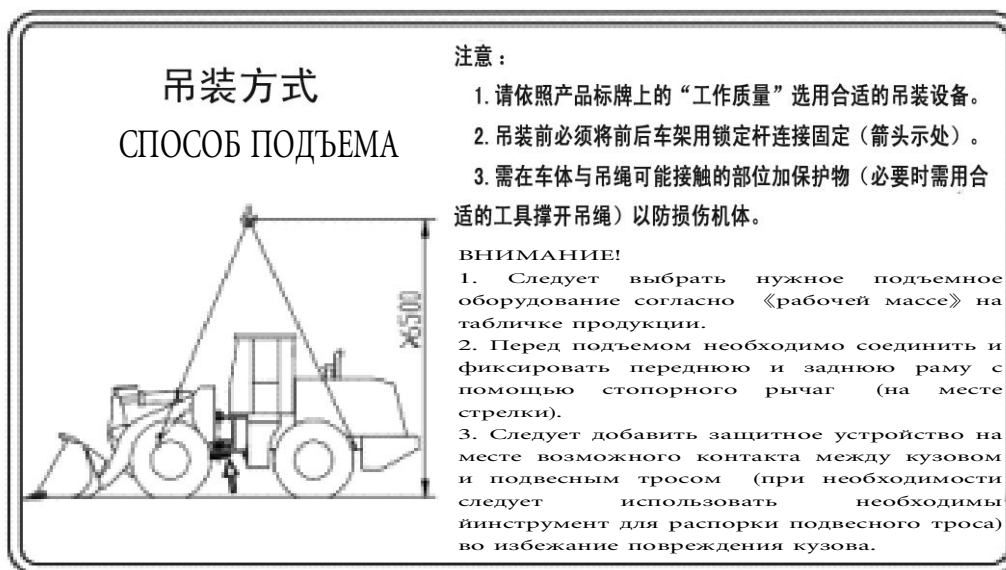
Рис.3-4 Схема подъема целой машины
