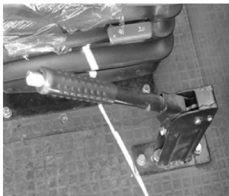
Рис.1-11 Схема стояночного торможения
