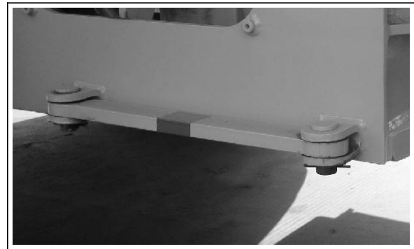
Рис.3-3 Фото арретированного штока поворота погрузчика
