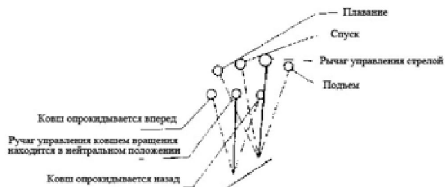
Рис.1-9 Схема разных положений рычагов управления
