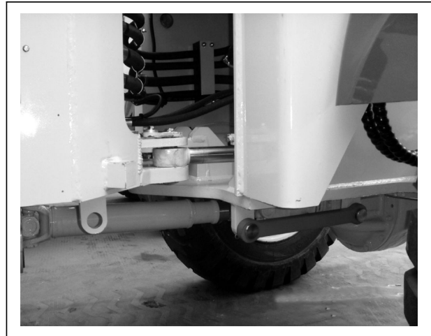
Рис.3-3 Фото арретированного штока поворота погрузчика
