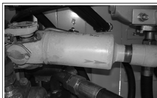
Точка смазки главного передаточного вала
