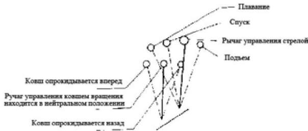
Рис.1-14 Схема разных положений рычагов управления
