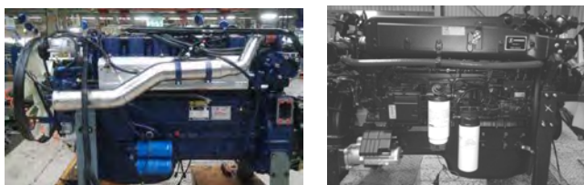
Место установки заводской таблички двигателя WP10 Место расположения маркировки на БЦ двигателя WP10
